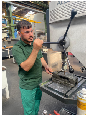
Hier wird die Bohrplatte gebohrt
